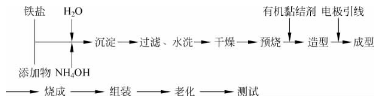
图 3-23 \alpha\text{-Fe}_2\text{O}_3 气敏元件制备工艺流程
