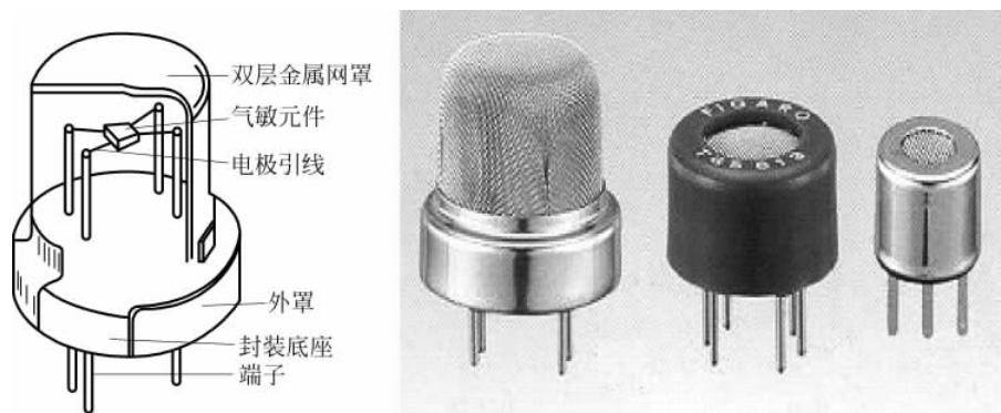
图 3-3 烧结型 \text{SnO}_2 气敏元件的外形结构
