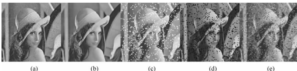
图 5.2.8 基本排序滤波器滤除脉冲噪声的效果
