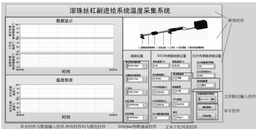
图 3-1 滚珠丝杠副温度测量模块前面板
