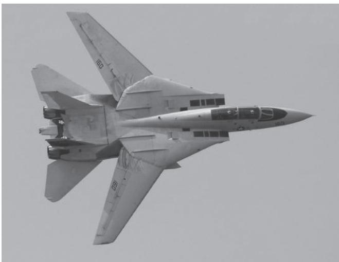
图 5.34 梯形翼飞机示意图
