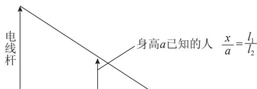
图 5.27 测量电线杆高的示意图
