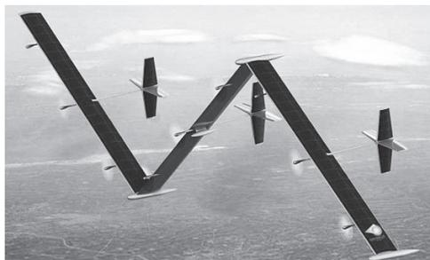
图 5.19 奥德修斯太阳能机翼可折叠飞机
