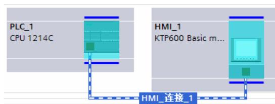
图 3-61 共享变量的 CPU 和 HMI 连接
