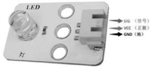
图 2-4 插槽各功能端口示意
