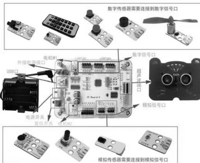
图 1-4 Arduino 主控板与传感器的连接方式
