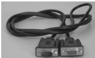
图 3.2 一端是 DB9 母头,另一端是 DB9 公头的配置线缆
