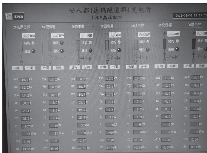
图3 高压10kV系统电力监控功能图
