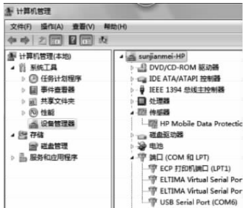
图 3-5 USB 转串口设备名称显示
