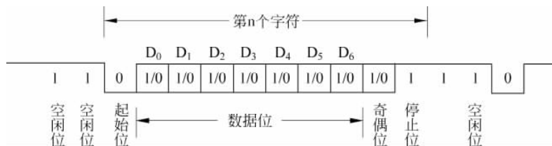
图 3-10 串行通信字符格式
