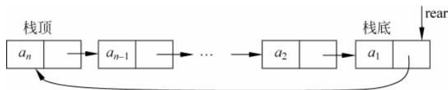
图 3.9 只有表尾指针没有表头指针的循环单链表
