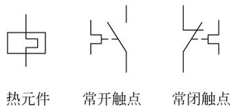
图 3.16 热继电器图形符号
