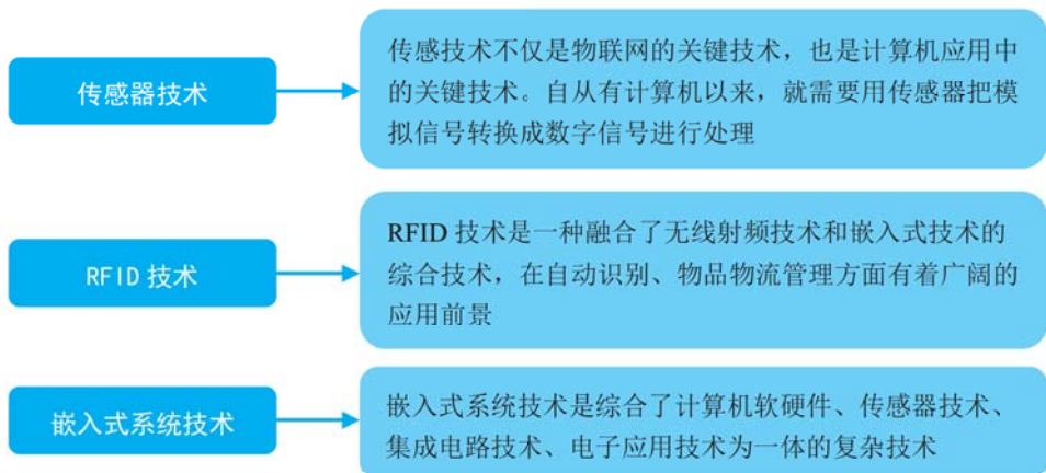
图 1-7 物联网应用的 3 项关键技术
