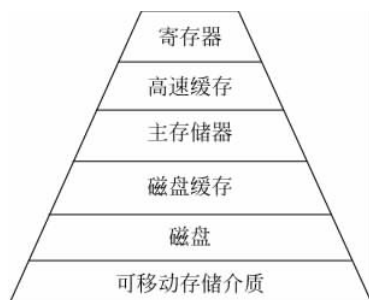
图 5-1 计算机系统存储器
