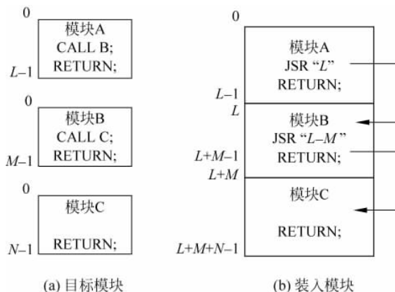
图 5-5 程序链接示意图
