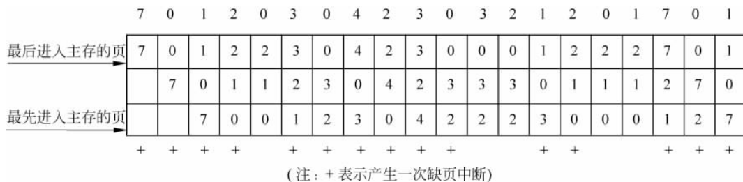
图 5-36 FIFO 置换算法主存中页面变化示意图
