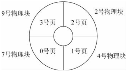
图 5-49 采用时钟置换算法
