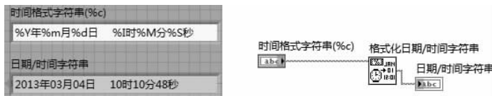
图 3-31 格式化日期/时间字符串函数的使用方法
