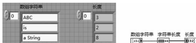
图 3-20 字符串长度函数的使用
