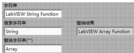
图 3-29 搜索替换字符串函数的使用方法
