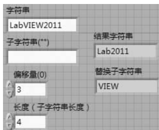
图 3-27 将指定的字符串删除
