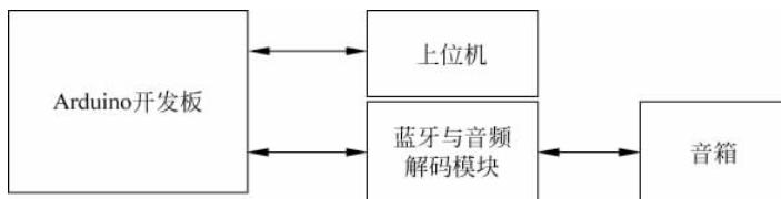
图 3-3 有线音箱无线化结构框架
