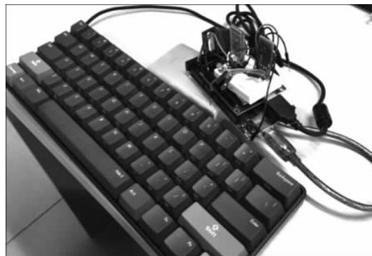
图 3-12 有线键盘无线化模块
