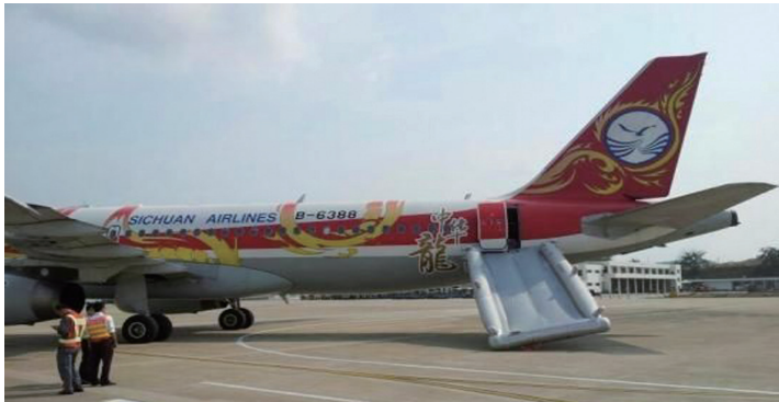
图 1-1 舱门应急滑梯在正常情况下被放出
