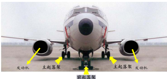
图 1-1 飞机的起落架和发动机位置
