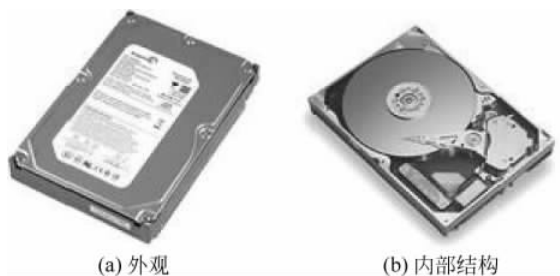
图 3.6 硬盘的外观和内部结构
