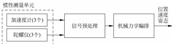
图 3-7 惯性导航系统的主要模块
