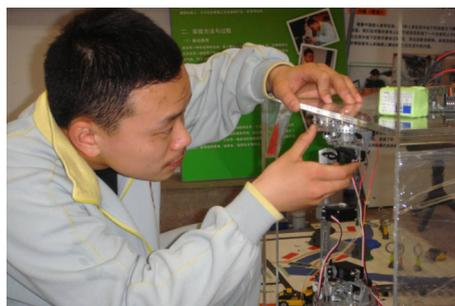
图1-22 爬壁机器人
