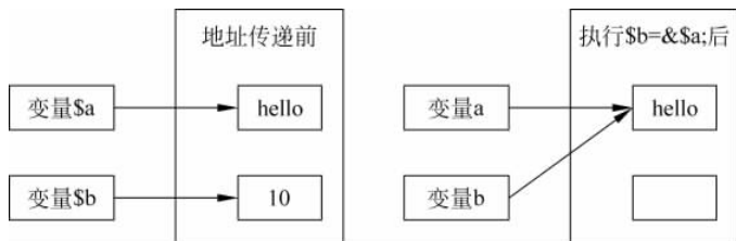
图 3-2 引用赋值——变量地址传递示意图
