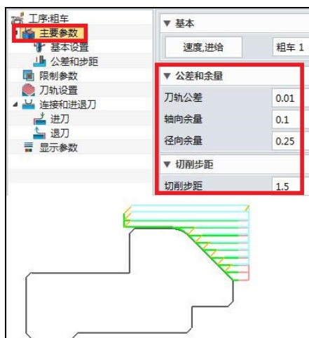
图 1.2.35 粗加工主要参数设置与结果
