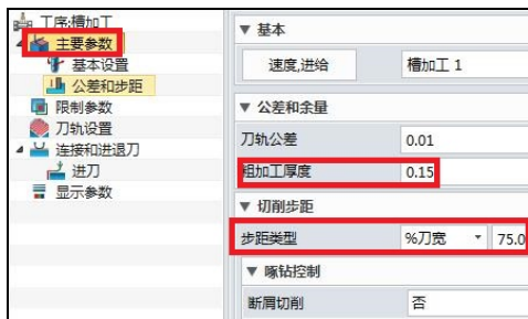
图 1.1.72 切槽参数的设置 1
