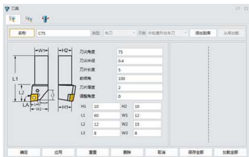
图 1.1.13 创建 C75 外圆刀
