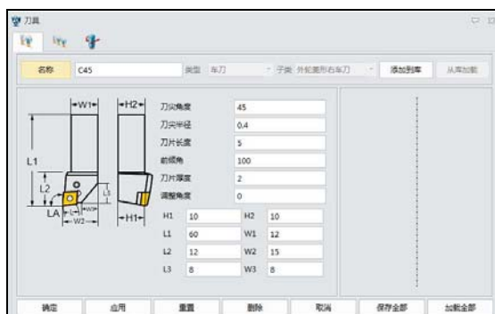
图 1.1.12 创建 C45 外圆刀
