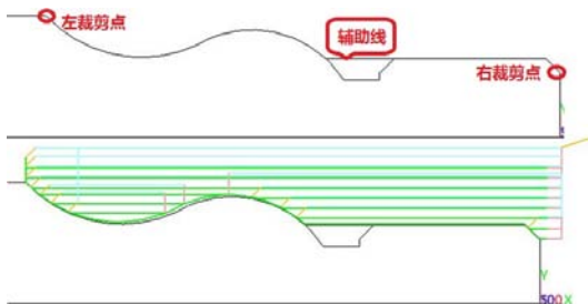
图 1.1.69 左右裁剪点及刀路结果
