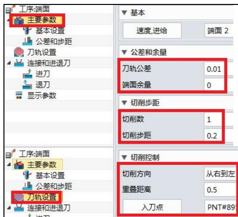
图 1.2.19 精加工主要参数设置
