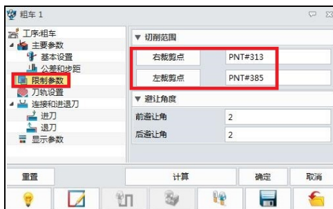
图 1.1.49 限制参数设置
