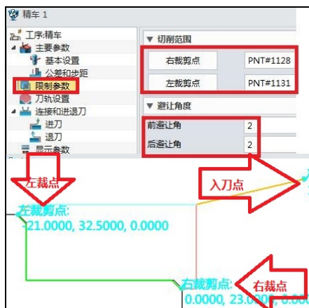
图 1.2.26 限制参数设置
