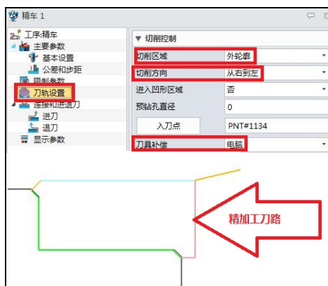
图 1.2.27 刀轨参数设置及精加工刀路
