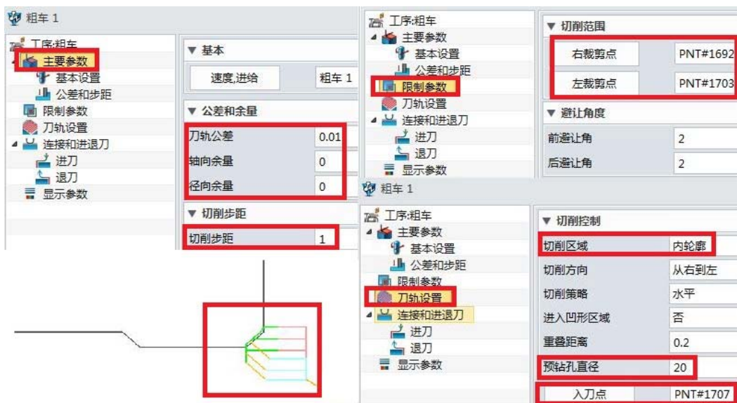
图 1.2.20 车内孔的主要参数设置及结果
