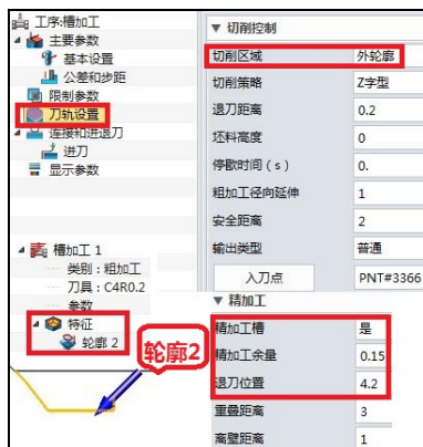
图 1.1.73 切槽参数的设置 2
