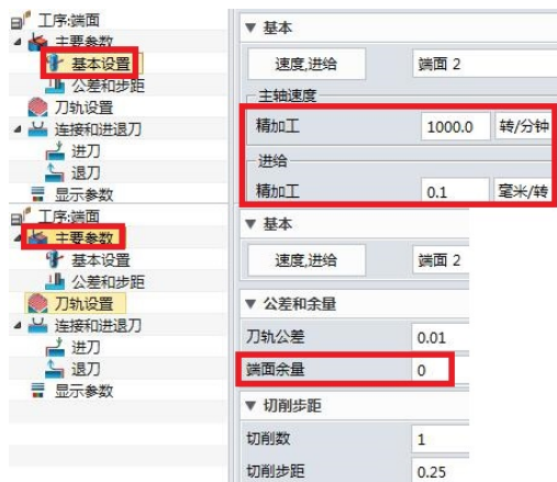
图 1.2.34 精加工主要参数设置
