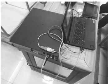
图 4-9 Console 配置路由器
