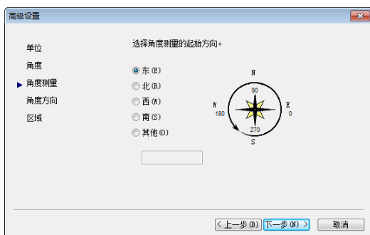
图 1-19 设置角度测量的起始方向
