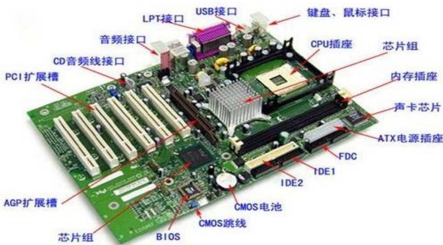
图1-11 主板各接口示意图
