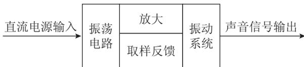
图 1-18 有源自激型蜂鸣器的工作发声原理
