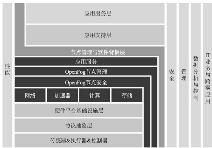
图 5.3 OpenFog 参考架构
