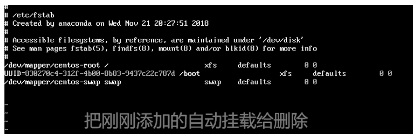
图 7-3 删除后的/etc/fstab 文件配置信息
