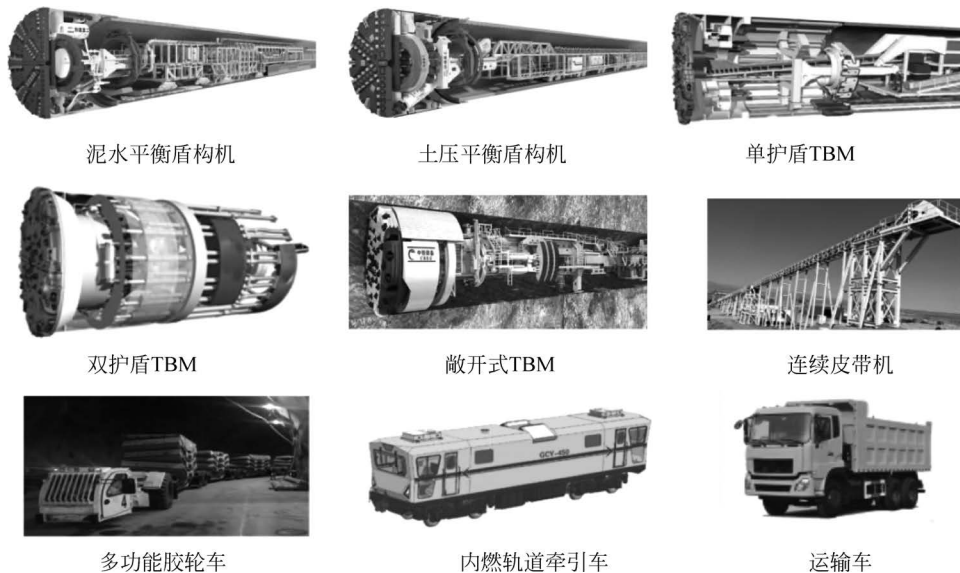
图 1-9 掘进机法主要施工机械示例
