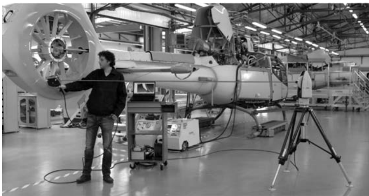
图 3-37 徕卡 AT960 型激光跟踪仪被用于测量空客直升机的外形参数
