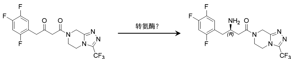
图 1-9-6 第三代西格列汀工艺合成路线: 转氨酶还原胺化?
