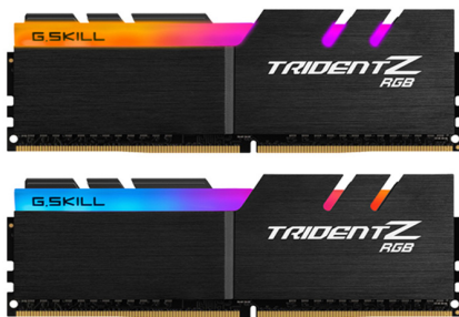
图 1-7 带散热鳍片的 DDR4 3200 内存
