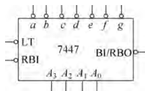
图 3.4.5 7447 七段显示译码器逻辑符号
