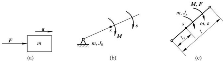
图 1-8 刚性构件模型
