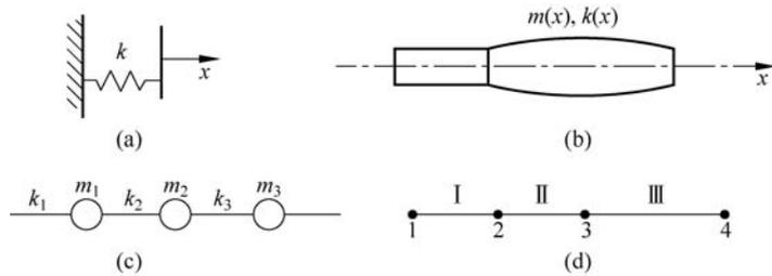
图 1-9 弹性元件模型
