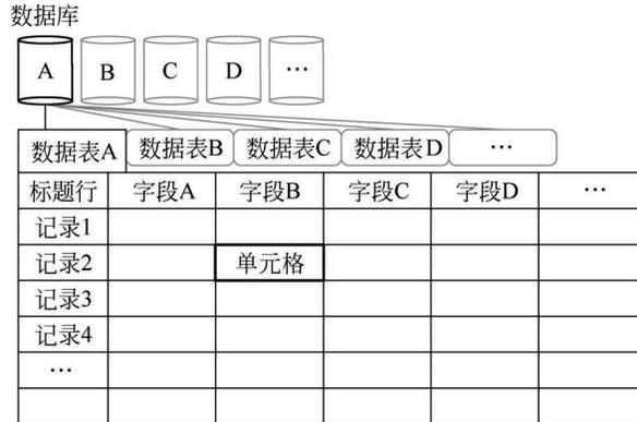
图 3-1 关系数据库结构示意图
