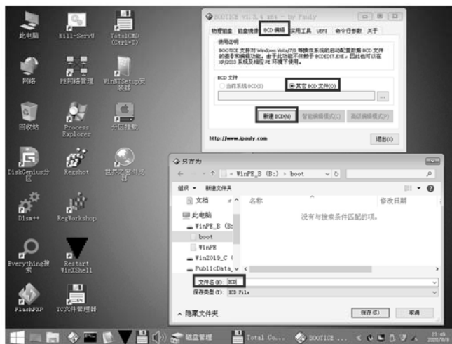
图 3-34 新建 B:\boot\BCD 启动菜单文件
