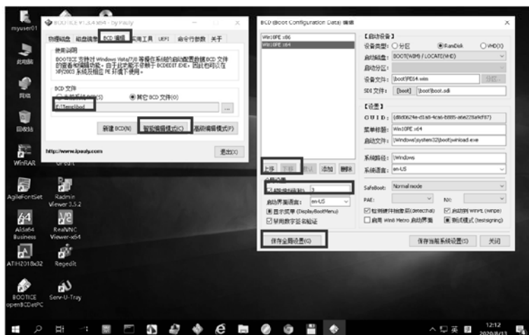
图 3-4 用 BootICE 修改 bod 中启动项目的启动顺序和延迟时间
