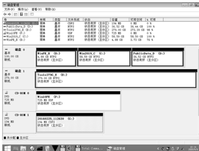
图 3-28 按分区规划为两块硬盘创建各个分区
