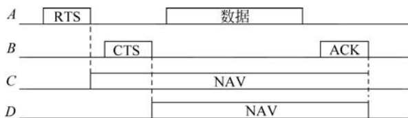
图 3.1 CSMA/CA 的虚拟载波侦听示例
