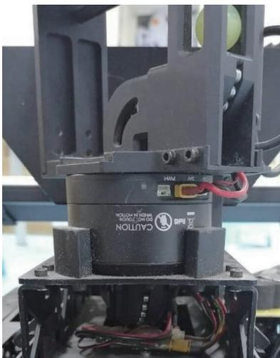
图 3.28 ICRA 官方车的 Yaw 轴实物结构
