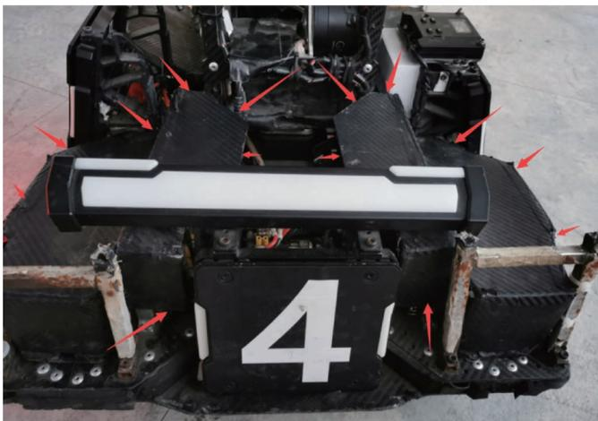
图 3.44 空隙保护
