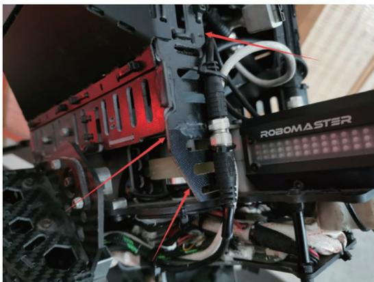
图 3.42 摩擦轮保护板材
