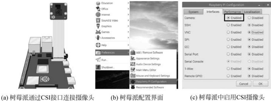
图 3.23 树莓派通过 CSI 接口连接摄像头及系统配置
