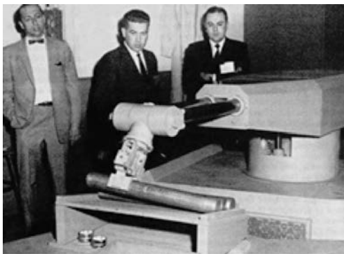
图 1-1 第一台用于压铸生产的机器人
