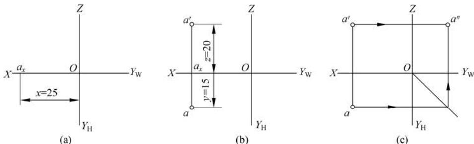
图 3.4 求作点的三面投影图
