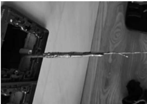
图 5-5 线缆头部和微光缆通过牵引绳绑定
