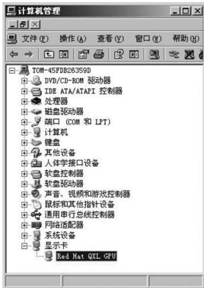
图 3-54 安装了 QXL 虚拟显卡驱动程序的 Windows Server 2003
