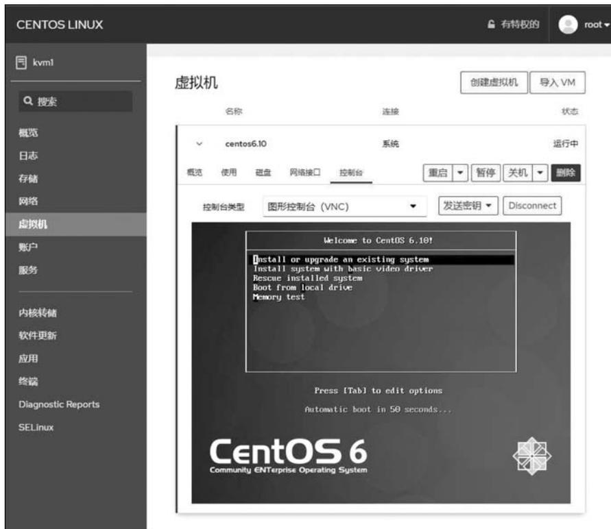
图 3-5 Cockpit 中虚拟机的控制台
