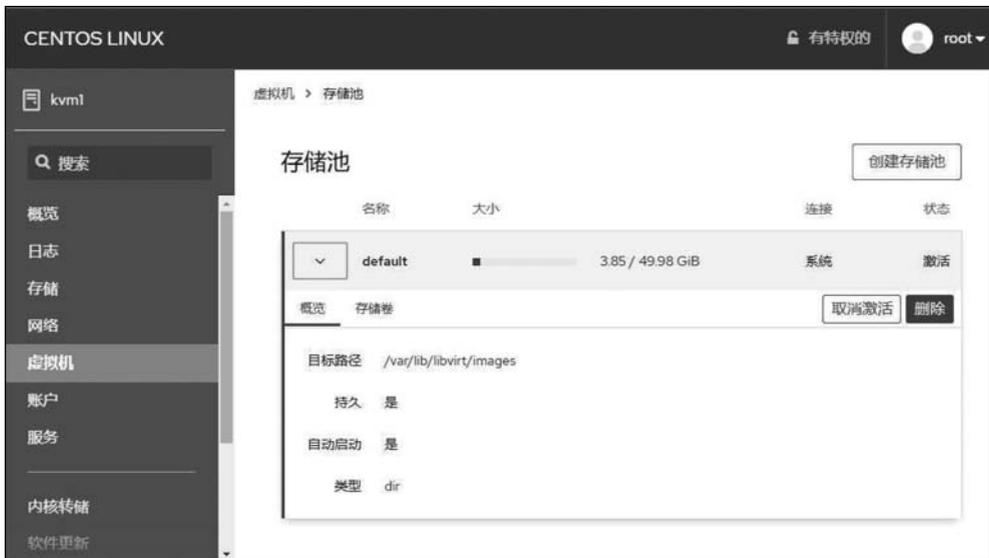
图 3-2 Cockpit 中的存储池
