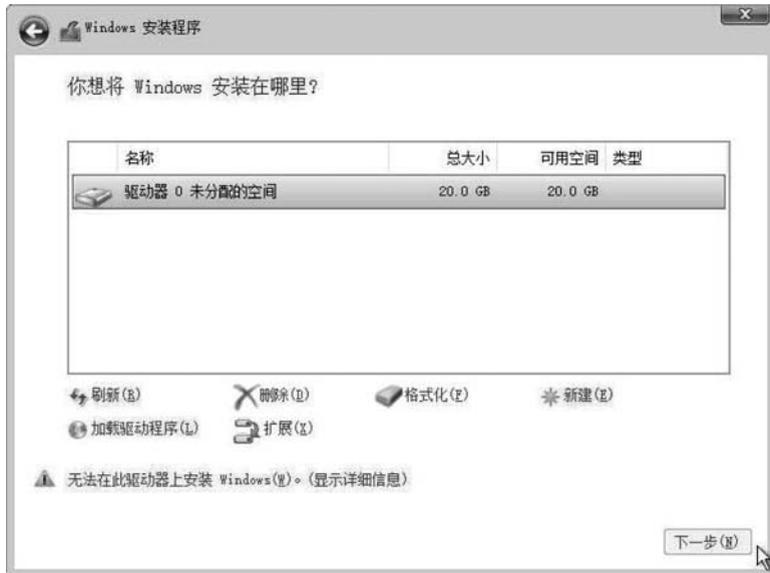
图 3-39 安装程序识别出 VirtIO 接口的磁盘
