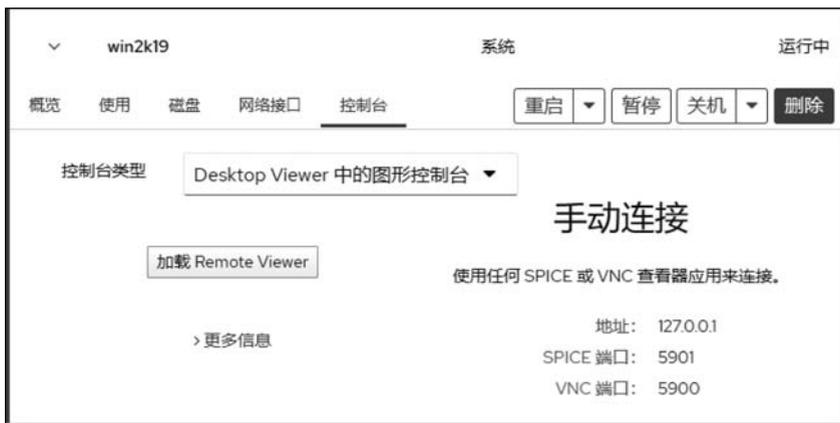
图 3-57 Cockpit 虚拟机控制台中显示的图形设备监听地址与端口
