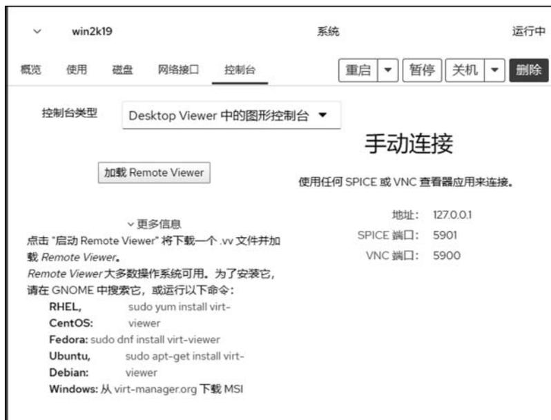
图 3-59 在 Cockpit 虚拟机控制台中使用 Remote Viewer 访问虚拟机
