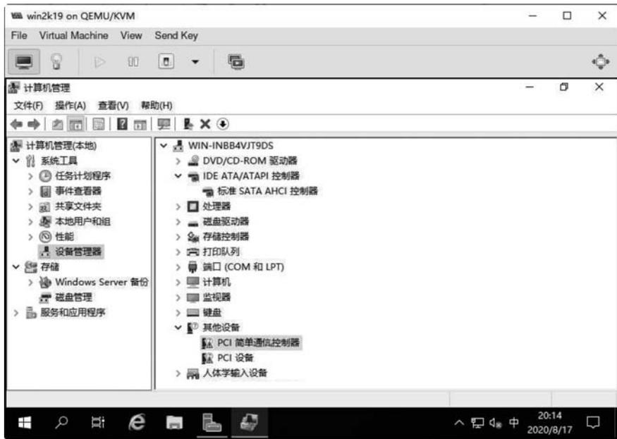
图 3-48 没有安装驱动程序的 VirtIO 串口控制器设备
