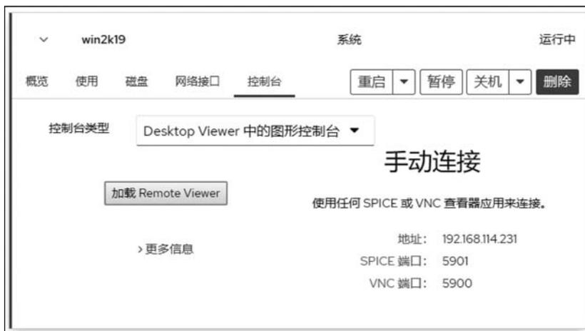
图 3-62 Cockpit 虚拟机控制台中显示的图形设备监听的地址与端口
