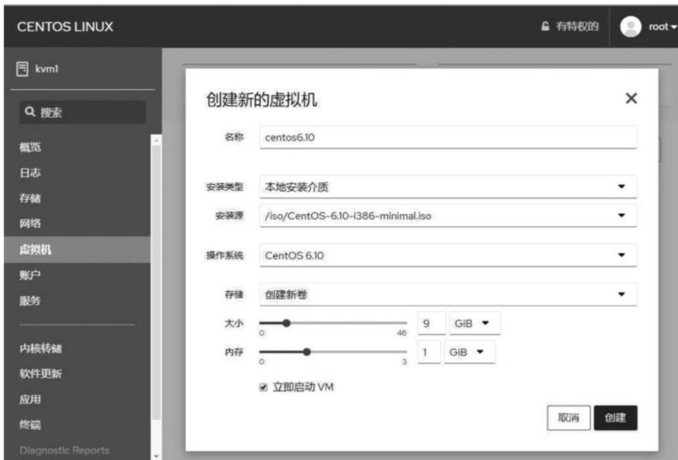
图 3-4 在 Cockpit 中创建新的虚拟机
