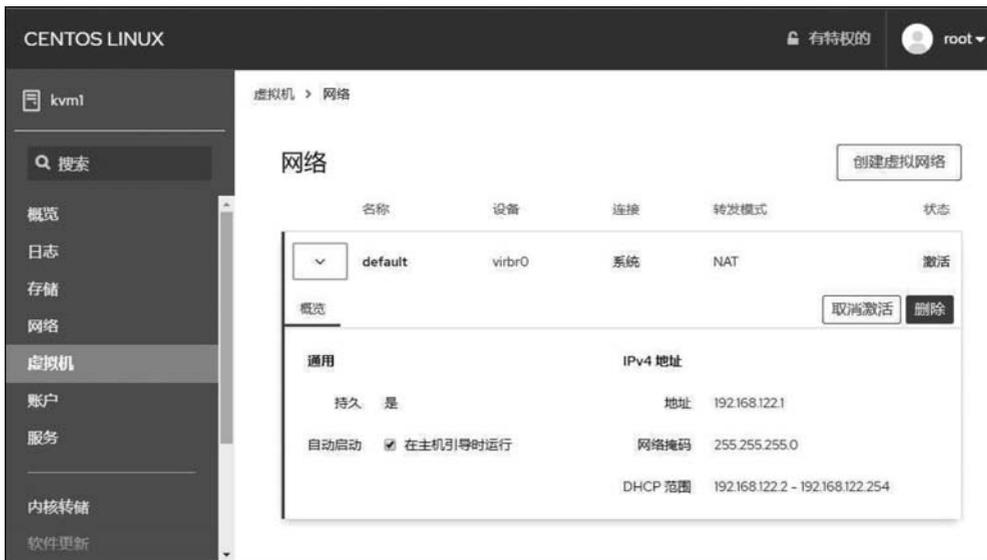
图 3-3 Cockpit 中的虚拟网络
