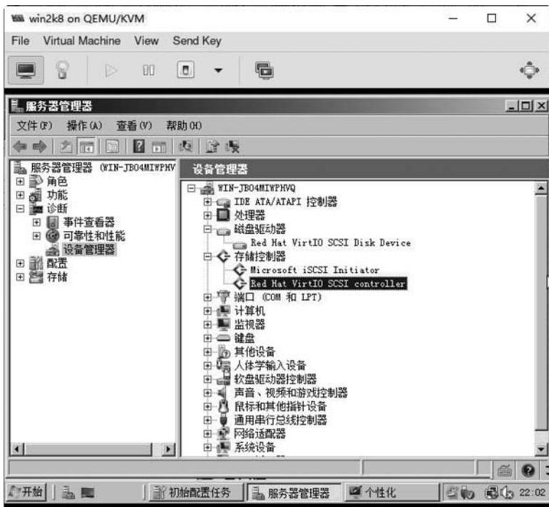
图 3-44 正确安装 VirtIO 存储控制器驱动程序的虚拟机
