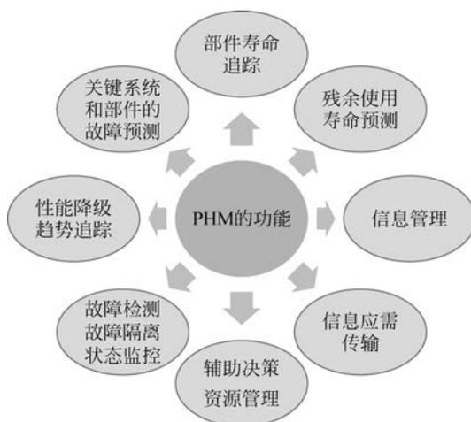
的诊断向基于智能系统的预测转变,从忽略对象性能退化的控制调节向考虑性能退化的控制调节转变,从静态任务规划向动态任务规划转变,从定期维修到视情维修转变,从被动保障到主动保障转变。故障预测可向短期协调控制提供参数调整时机,向中期任务规划提供参考信息,向维护决策提供依据信息。故障预测是实现控制参数、任务规划和视情维修的前提,是提高装备六性(可靠性、安全性、维修性、测试性、保障性和环境适应性)和降低全寿命周期费用的核心。近年来,PHM 技术受到了学术界和工业界的高度重视,在机械、电子、航空、航天、船舶、汽车、石化、冶金和电力等多个行业领域得到了广泛的应用。
