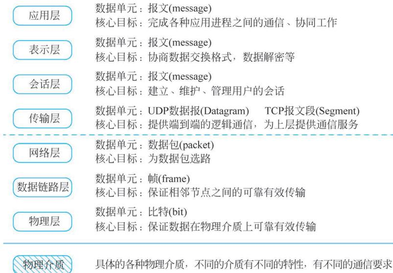
图 3-26 分层模型中的各层对象和功能
