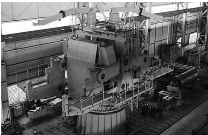
图 1-1 连铸机双臂钢包回转台
