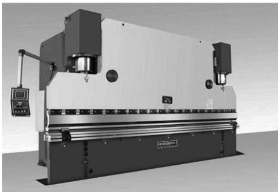
图 1-9 CNC 液压折弯机
