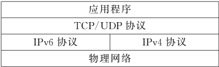
图 5-36 IPv4/IPv6 双协议栈结构示意图
