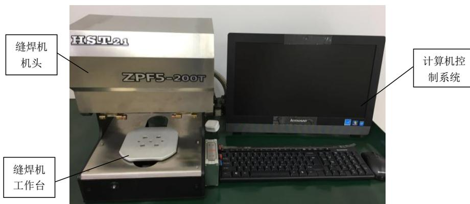
图 2-1 平行缝焊机
