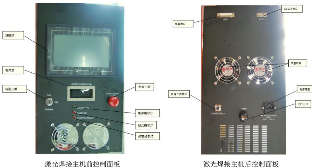
图 2-17 激光焊接机
