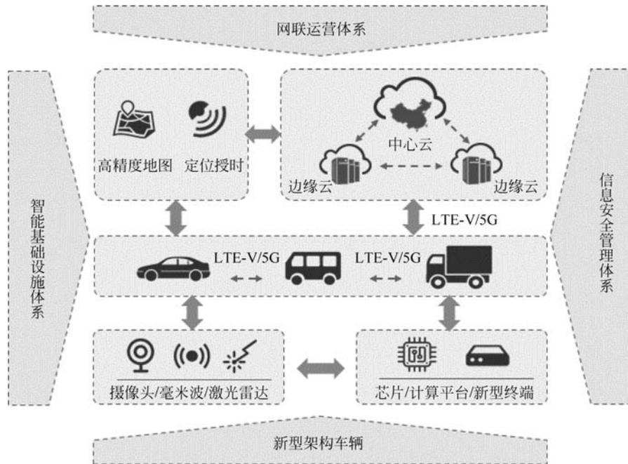
图 1-6 车路云一体化系统体系架构
