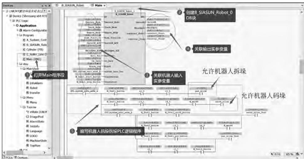
图 5-60 机器人调度主程序
