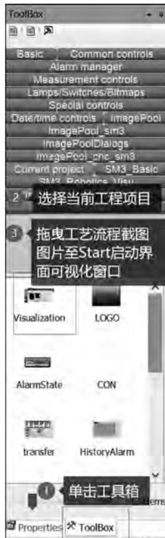
图 5-40 添加工艺流程图片
