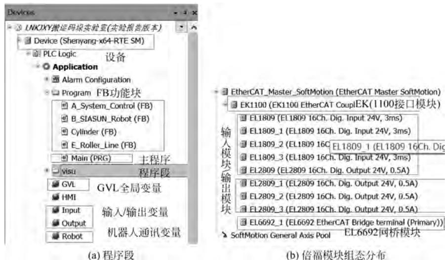
图 5-47 CODESYS 工程程序架构
